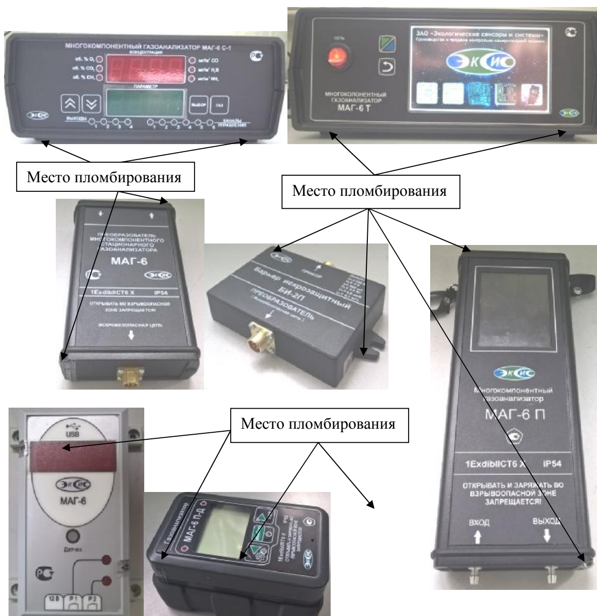
Стрелками указаны места пломбирования от несанкционированного доступа Рисунок 9 Схема пломбирования газоанализаторов от несанкционированного доступа
