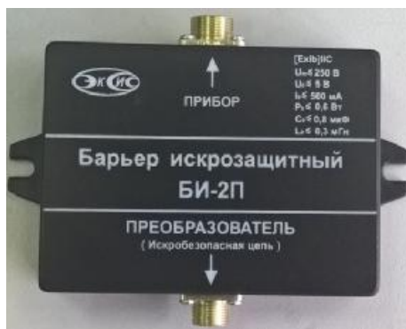
Рисунок 8– Внешний вид барьера искрозащиты БИ-2П
