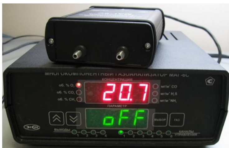
Рисунок 5 – Внешний вид газоанализатора МАГ-6 исполнения МАГ-6 С-1 (с одним внешним измерительным преобразователем МАГ-6)
